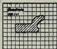
SEZIONE CORNICE DI INTELLAIATURA DEL PIANO
