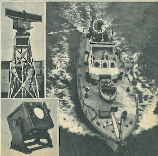
Sotto: Radar per imbarcazioni fluviali della « Decca Navigator Ltd. »; a sinistra: l'antenna, e in basso il piccolo schermo fluorescente.
