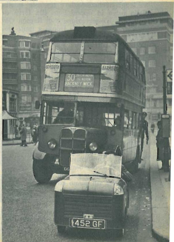
Una minuscola automobile a 2 cilindri, 4 tempi, 2\frac{1}{2} cv. Ha tre velocità e fa 85 Km/h.
